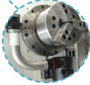
Датчик привязки инструмента Renishaw HPMA (Великобритания)
