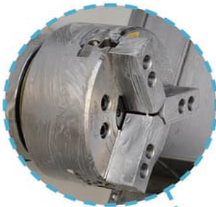
Патрон 3-х кулачковый гидравлический 8 дюймов Autogrip/SEOAM (Тайвань)
