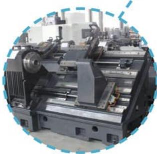
Станина из серого чугуна (Mehanit)
