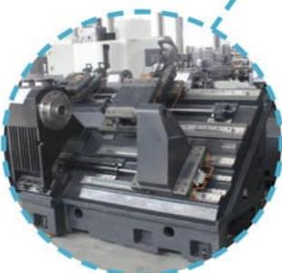
Станина из серого чугуна (Mehanit)
