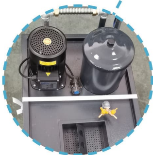
Станция фильтрации СОЖ с насосом
