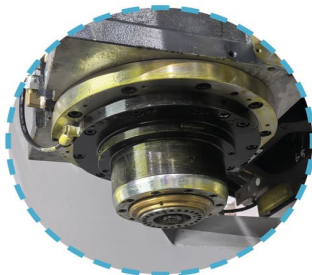
Шпиндель HSK-A63 (20/28 кВт)
