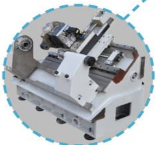
Станина из серого чугуна (Mehanit)
