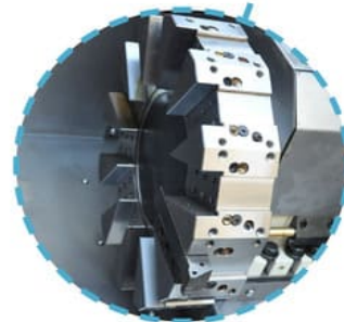
Серворевольверная головка 12 позиций (без привода) (Тайвань)
