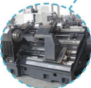
Станина из серого чугуна (Mehanit)
