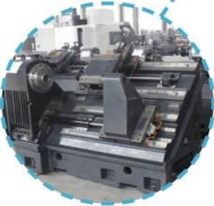
Станина из серого чугуна (Mehanit)
