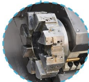
Ревolverная головка 8 позиций (без привода) (Тайвань)
