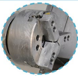
Патрон гидравлический 3-х кулачковый 6 дюймов (Тайвань)
