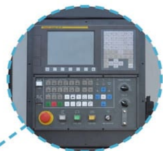
Система управления Fanuc Oi Tf(5) Plus (Япония) Сервоприводы X/Z Fanuc Bis8B/3000/Bis12/2000 (Япония)
