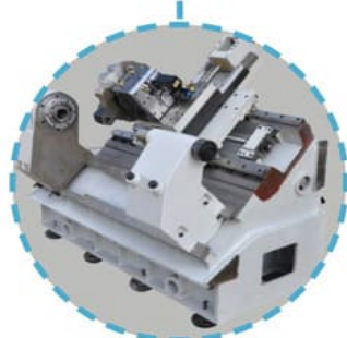
Станина из серого чугуна ( Mehanit )
