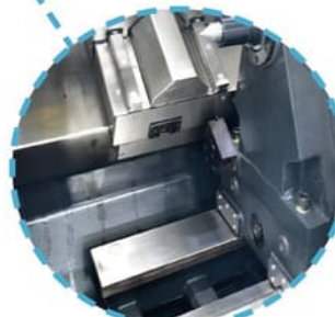
Гидравлическая программируемая пиноль задней бабки, в комплекте с вращающ центром
