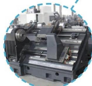
Станина из серого чугуна (Mehanit)
