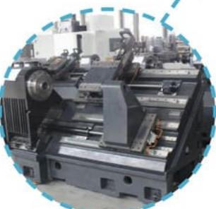
Станина из серого чугуна (Mehanit)
