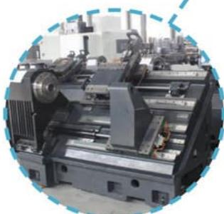
Станина из серого чугуна (Mehanit)
