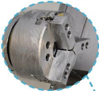
Патрон 3-х кулачковый гидравлический 10 дюймов Autogrip/SEOAM (Тайвань)
