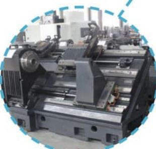
Станина из серого чугуна (Mehanit)
