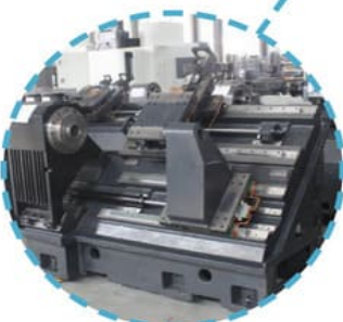
Станина из серого чугуна (Mehanit)
