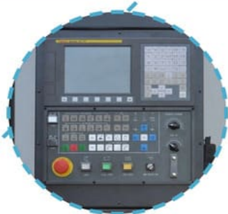
Система управления Fanuc Oi Tf(5) Plus (Япония) Сервоприводы X/Z Fanuc Bisc12/3000/Bisc12/3000 (Япония) Система диалогового программирования Manual Guide Oi
