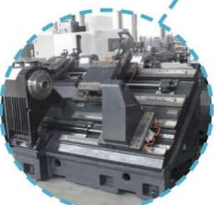
Станина из серого чугуна (Mehanit)
