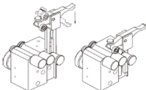
◆ Закрепляет инструмент от 0 до 40 мм, биение около 2 мкм
