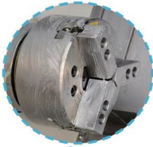
Патрон гидравлический 3-х кулачковый 6 дюймов (Тайвань)
