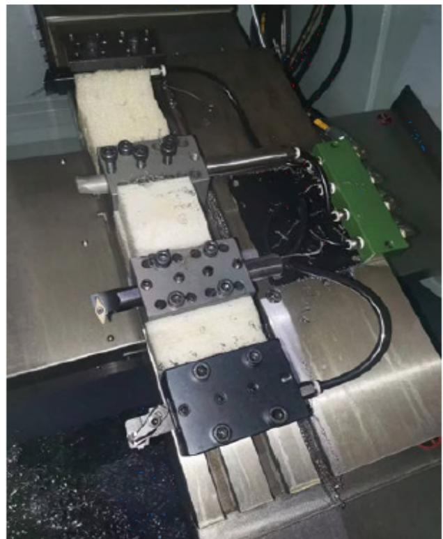
2. Улавливатель деталей с ленточным транспортером и накопителем.
