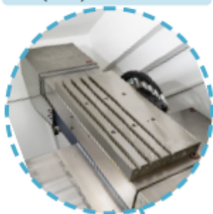
Инструментальная панель (стол) с Т-пазами
