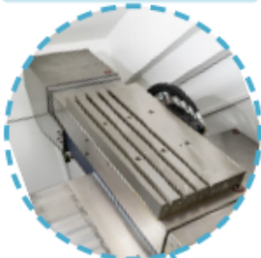
Инструментальная панель (стол) с Т-пазами
