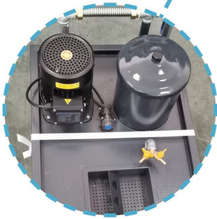
Станция фильтрации СОЖ с насосом
