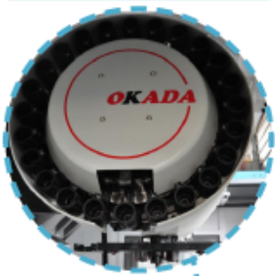
Инструментальный магазин с АТС (24/32/40позиций)
