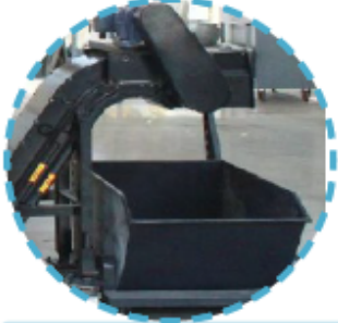
2-а шнековых + скребковый конвейеры с баком для стружки
