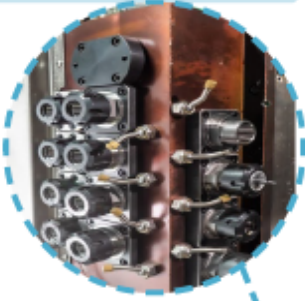
Блок приводных инструментов по осям -X/Y/Z
