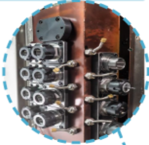
Блок приводных инструментов по осям -X/Y/Z
