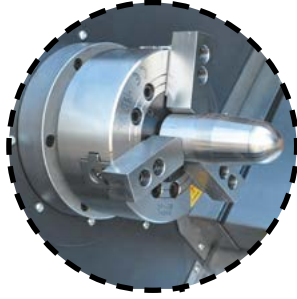
Трехлапчатый токарный патрон 8 дюймов
