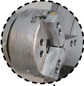
Трехкулачковый токарный патрон 8 дюймов
