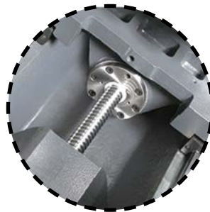
Шарико-винтовые передачи NSK (Япония)
