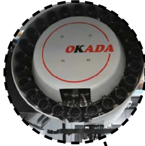
Автоматическая смена инструмента (24 позиции)
