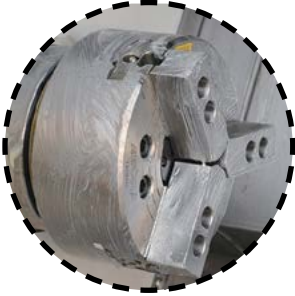
Трёхлапчатый токарный патрон 8 дюймов
