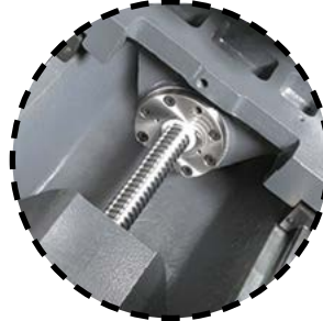
Шарики-винтовые передачи NSK (Япония)
