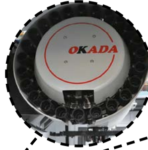
Автоматическая смена инструмента (24 позиции)
