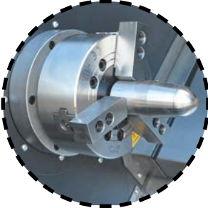
Трехкулачковый токарный патрон 12 дюймов
