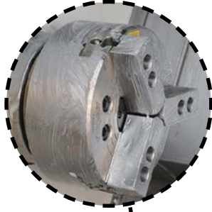
Трехлапчатый токарный патрон 8 дюймов
