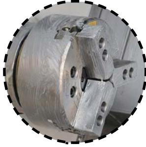
Трехлапчатый токарный патрон 6 дюймов
