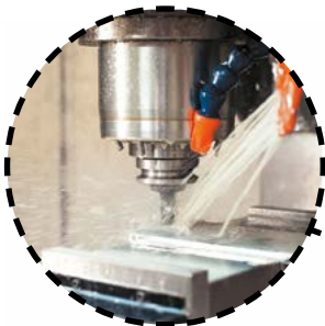
Система подачи СОЖ через шпиндель (30 бар)
