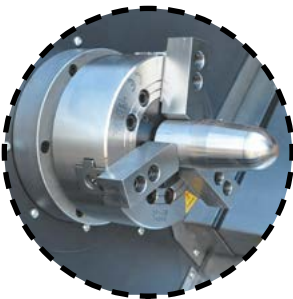
Трехкулачковый токарный патрон 12 дюймов
