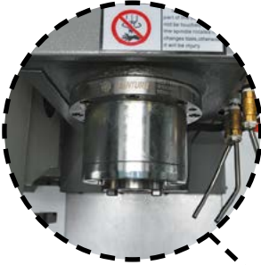
Шпиндель BT40 (11/15 кВт, 12000 об/мин)
