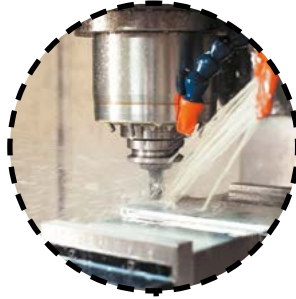
Система подачи СОЖ через шпиндель (30 бар)
