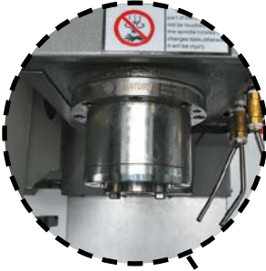
Шпиндель BT40 (11/15 кВт, 12000 об/мин)
