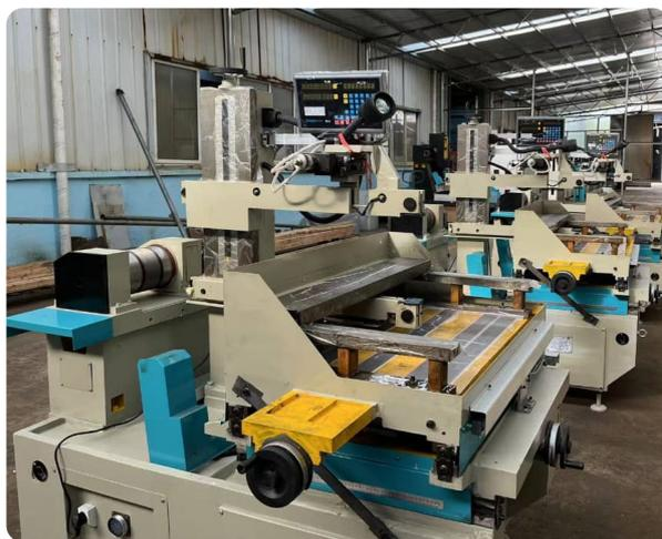
В качестве режущего инструмента используется многоцветная молибденовая проволока диаметром от 0.10 до 0.25 мм, что позволяет снизить расходы на ее замену.
