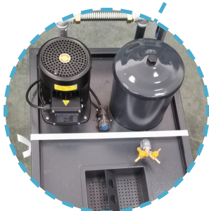
Станция фильтрации СОЖ с насосом
